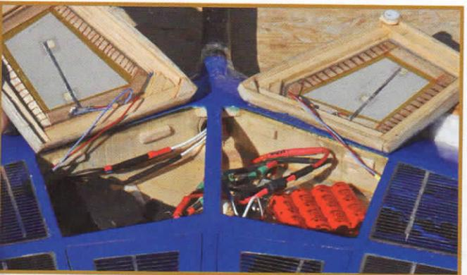
On voit bien en haut les cellules épousant la forme du profil de l'aile. L'ouverture des trappes révèle comment elles sont fixées sur leurs supports, chauffés pour être courbés (stries foncées)
