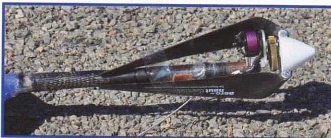
L'ensemble motopropulseur : le moteur est un classique du vol indoor, le Hacker A10-13L de 20 g associé à une hélice Aero-Naut Camprop 15x13" via une réducteur 1:5.
