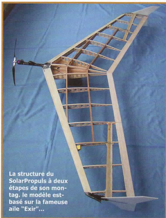
La structure du SolarPropuls à deux étapes de son montage, le modèle est basé sur la fameuse aile "Exir"...
