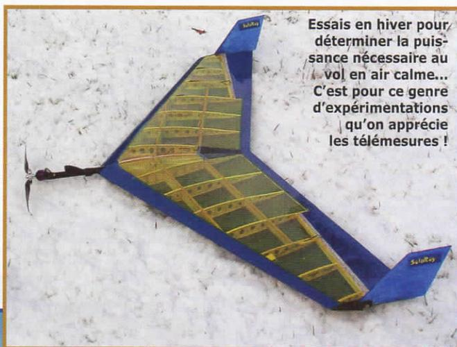
Essais en hiver pour déterminer la puissance nécessaire au vol en air calme... C'est pour ce genre d'expérimentations qu'on apprécie les télémesures !
